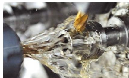
**СОЖ для высокоскоростного резания (High Speed Cutting, HSC)** бесцинковые, с низким содержанием ароматических углеводородов, не склонные к образованию масляного тумана и обладающие низкой степенью испарения
